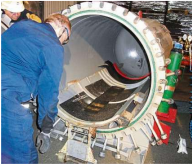
Der Bergungsbehälter, in den das beschädigte Schwefeldioxid-Gefäß verschlossen wurde, musste aus Hanau nach Planig gebracht werden. Foto: Feuerwehr
